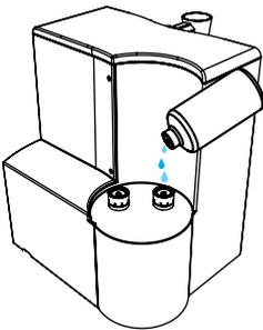
1. Den Wassertank abnehmen und die beiden Stößel auf der Rückseite des Gerätes mit Entkalkungsmittel befüllen. Nach einigen Minuten vorsichtig alle dabei nach oben schwimmenden Fremdpartikel entfernen.
