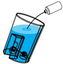
5. 1,7 L Leitungswasser in den Wassertank füllen und 50 ml Entkalkungsmittel hinzufügen. Bei starker Verkalkung die Menge des Entkalkungsmittels verdoppeln.
