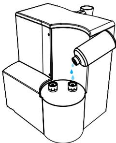
1. Den Wassertank abnehmen und die beiden Stößel auf der Rückseite des Gerätes mit Entkalkungsmittel befüllen. Nach einigen Minuten vorsichtig alle dabei nach oben schwimmenden Fremdpartikel entfernen.
