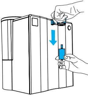
5. Mit einer Hand den oberen Bereich immer noch festhalten und den Sterilfilter mit der anderen Hand nach unten wegziehen.
