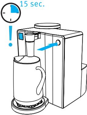
3. Die Start-Stopp-Taste (genau **fünfzehn** Sekunden lang) **gedrückt halten**, bis im Display „RSP“ angezeigt wird. Danach die Start-Stopp-Taste loslassen. Die Membranspülung beginnt.
