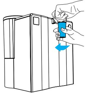
**3.** Mit der anderen Hand den Bereich unter dem Leuchtring ca. 5 mm nach links drehen.
