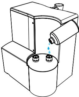
1. Den Wassertank abnehmen und die beiden Stöbel auf der Rückseite des Gerätes mit Desinfektionsmittel befüllen. Nach einigen Minuten vorsichtig alle dabei nach oben schwimmenden Fremdpartikel entfernen.
