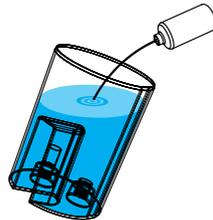
2. 1,7 L Leitungswasser in den Wassertank füllen und 50 ml Entkalkungsmittel hinzufügen. Bei starker Verkalkung die Menge des Entkalkungsmittels verdoppeln.
