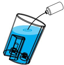
5. 1,7 L Leitungswasser in den Wassertank füllen und 100 ml Desinfektionsmittel hinzufügen.
