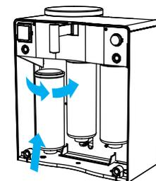
11. Den Vorfilter, bei Schritt 3 herausgedreht, per Hand an Position 1 bis zum Anschlag ein drehen.
