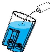
4. 1,7 Liter kühles Leitungswasser in den Wassertank füllen und 100 ml original aqua living Desinfektionsmittel (H<sub>2</sub>O<sub>2</sub> in 3% Lösung) hinzufügen.
