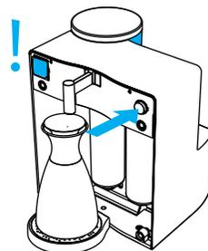
6. Die Start-Stopp-Taste genau fünf Sekunden lang drücken. Der Desinfektionsvorgang beginnt und wird im Display durch "REF" angezeigt.
