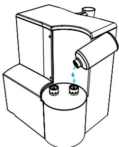
1. Den Wassertank abnehmen und die beiden Stößel auf der Rückseite des Gerätes mit Desinfektionsmittel befüllen. Nach einigen Minuten vorsichtig alle dabei nach oben schwimmenden Fremdpartikel entfernen.
