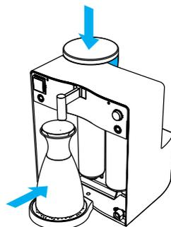
5. Ein Gefäß unter den Wasserauslauf stellen und den gefüllten Wassertank aufsetzen. Aus dem Wasserauslauf tritt während der Desinfektion Wasser aus.
