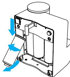
3. Den Vorfilter von Position 1 per Hand herausdrehen und nach unten abziehen. **Ihn nicht entsorgen!** Er wird später wieder eingesetzt.
