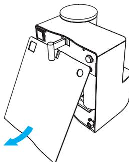
2. Die Frontblende vom Gerät lösen (Magnethalter) und nach unten wegziehen.
