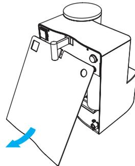
1. Die Frontblende vom Gerät lösen (Magnethalter) und nach unten wegziehen.
