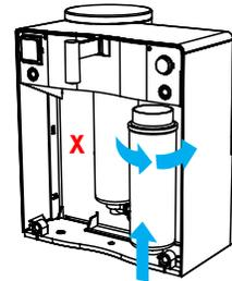
4. Den gelben Stöpsel aus dem neuen Vorfilter herausziehen und den neuen Vorfilter per Hand an Position 3 ein drehen.
