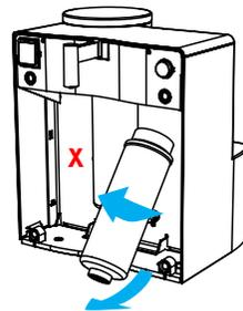
3. Den Keramikfilter von Position 3 herausdrehen. Ihn nicht entsorgen! Er wird später wieder eingesetzt.
