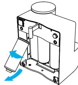
2. Den Vorfilter von Position 1 per Hand herausdrehen, nach unten abziehen und entsorgen.
